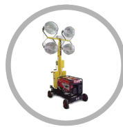
Genset + lampu sorot
